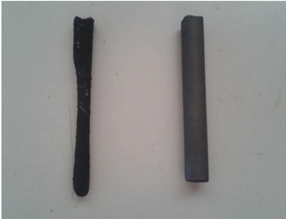
FIGURA 5 – Desgaste do eletrodo pós eletrólise (esquerda)
